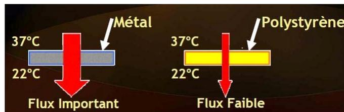
Lorsqu'une paroi (de surface S et d'épaisseur e) est soumise à un écart de température  $\Delta T$  entre ses deux faces, elle est traversée par un flux énergétique  $\Phi$ .
